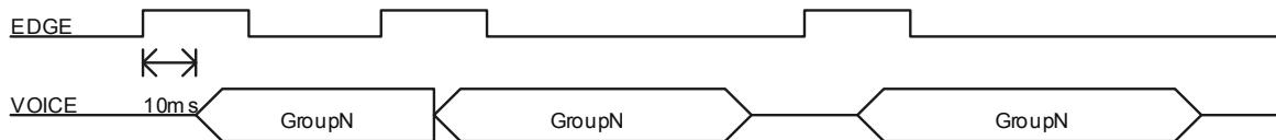
收到正脉冲信号后开始播放语音，在语音结束前如果还收到第二次正脉冲信号，则重新开始播放语音，在语音播放的过程中无收到正脉冲信号则播放完整段语音。
