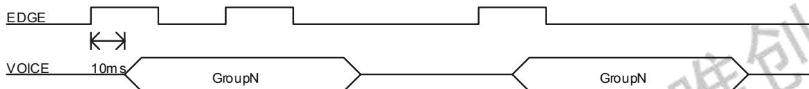
收到正脉冲信号后开始播放语音，在语音结束前如果再次收到正脉冲信号，则没有动作产生，在语音播放结束后再次收到正脉冲信号才会重新播放语音。
