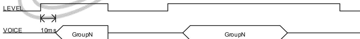
收到高电平后播放语音，高电平信号停止时，语音也停止播放。即时一直保持高电平信号，在语音播放完毕后也不再有任何动作。
